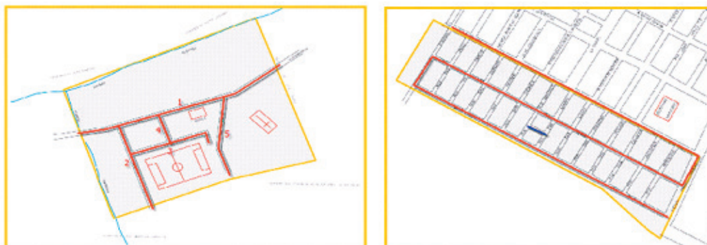
Figura 8.9 – Detalhes das diferentes formas de levantamento em quadra de polígono irregular e aberto e em linha reta para posterior fechamento das quadras
